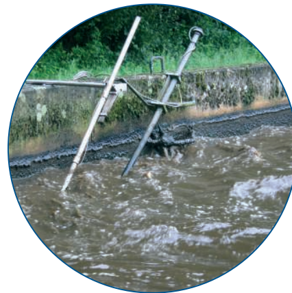
Afb. 7: Zelfs onder zware gebruiksomstandigheden blijft het benodigde onderhoud aan de LDO-sensor minimaal.
