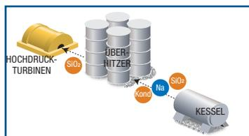
Unter den hohen Drücken und Temperaturen der heutigen Kraftwerke gewinnt das Problem der Dampflosigkeit von anorganischen Verbindungen zunehmend an Bedeutung.
