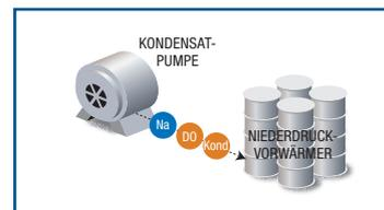
Die Kondensatreinigung spielt eine entscheidende Rolle in der Kreislaufchemie von Kraftwerken, da hiermit die Übertragung von Metalloxiden und ionischen Verunreinigungen in den Dampf-
