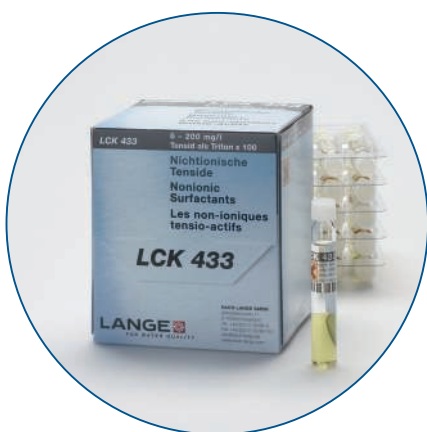
Abb. 2: LANGE Küvetten-Test LCK433 für nichtionische Tenside
