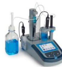
Titralab AT1000 Serie Potentiometrischer Titrator, 1 Bürette
