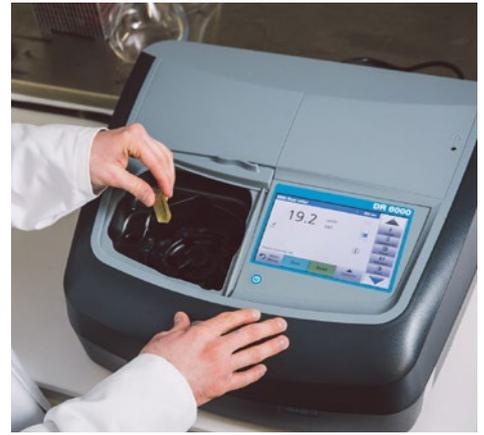
Abbildung 2. FAN-Messung mit einem DR6000 UV-VIS Spektralphotometer
