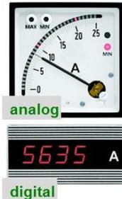
Mit der digitalen Technik wird das analoge Signal vom Sensor direkt innerhalb der Elektrode von analog zu digital gewandelt. Dieses neue digitale Signal wird durch Kabel und Steckverbindungen zum Messgerät geleitet, wo Anzeige und Speicherung stattfinden. Damit befindet sich kein elektronisches Bauteil mehr im „Messgerät“, welches die Originalsignale (mV) manipulieren kann.
