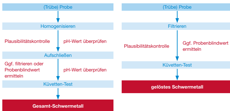
Abb. 2: Arbeitsschritte zur Bestimmung des Gesamt-Schwermetallgehaltes bzw. des Gehaltes an gelösten Schwermetallen.
