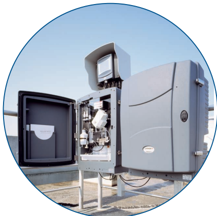
Abb. 4: PHOSPHAX sc für die kontinuierliche ortho-Phosphat Bestimmung zur optimalen Steuerung der P-Elimination
