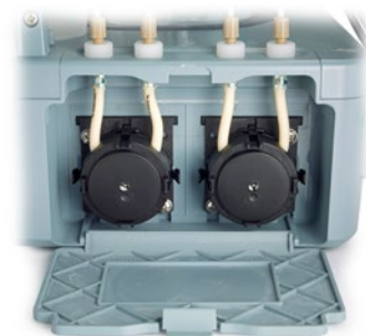
1 externe und 2 integrierte Peristaltikpumpen
