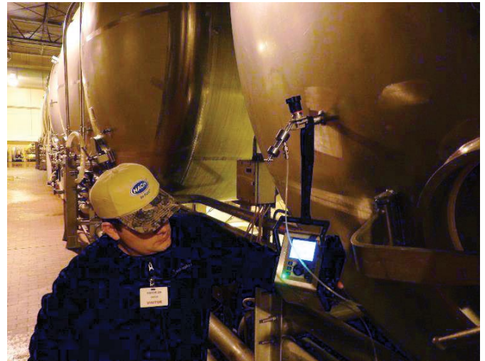
Abb. 4. Der tragbare Orbisphere 3100 bei der Online-Überprüfung
